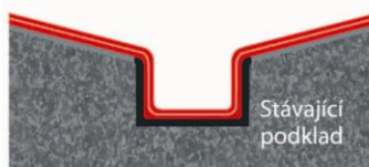
Vnitřní žlab Enke – tekutá umělá hmota s polyflexní vlísovou vložkou
