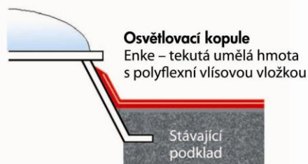
Napojení Enke – tekutá umělá hmota s polyflexní vlísovou vložkou
